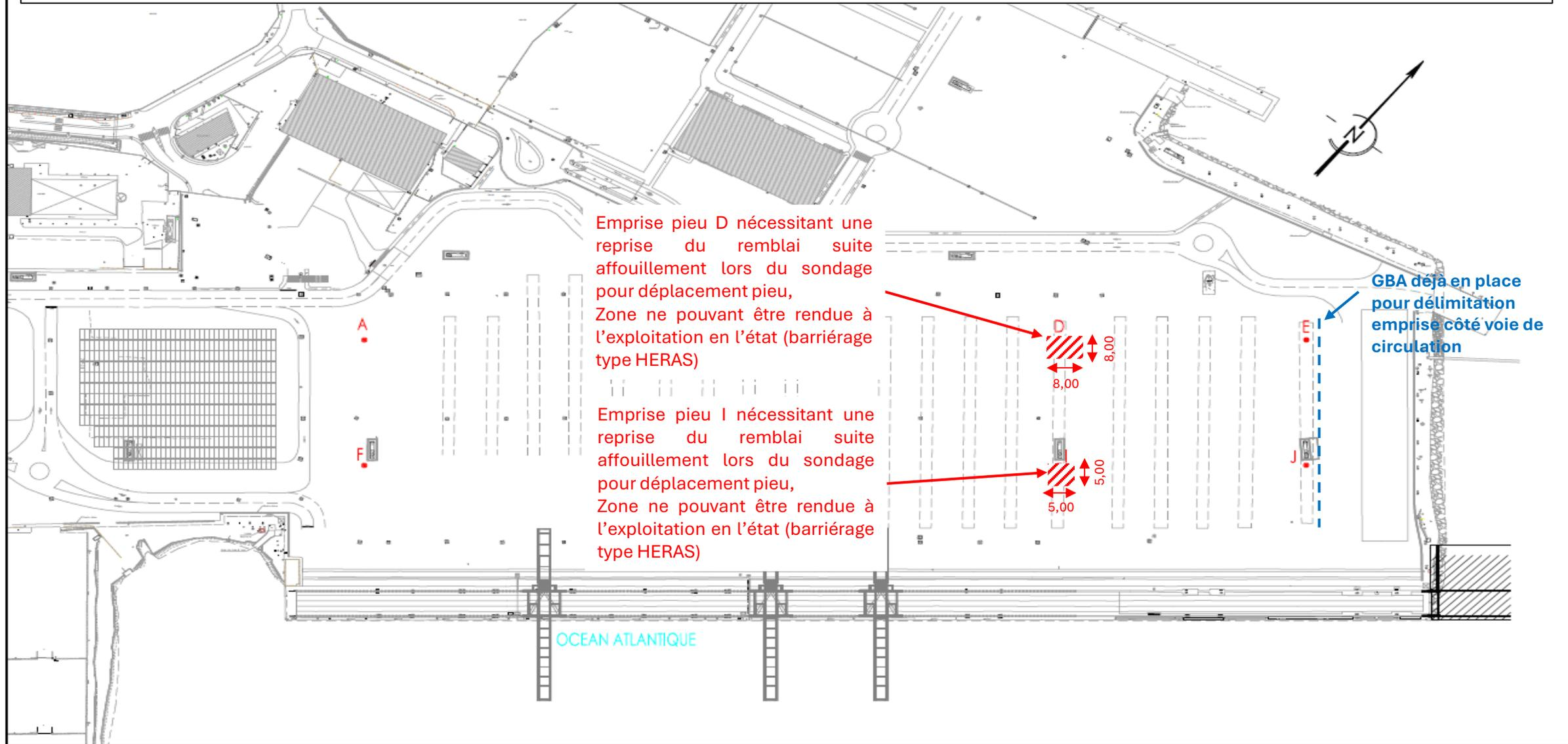
Emprise pieu D nécessitant une reprise du remblai suite affouillement lors du sondage pour déplacement pieu, Zone ne pouvant être rendue à l'exploitation en l'état (barriérage type HERAS)
