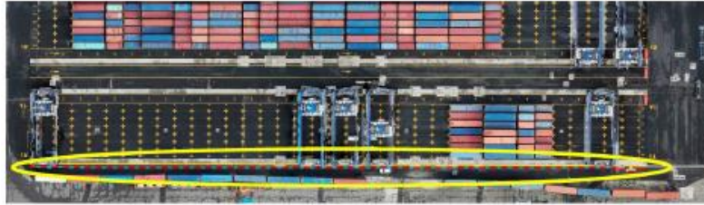
57 GBA de 2.5m (en rouge) par bloc, espacés de 1.5m (en bleu), en limite de champs de câbles Voir détails coté Ouest et Est slide suivant.
