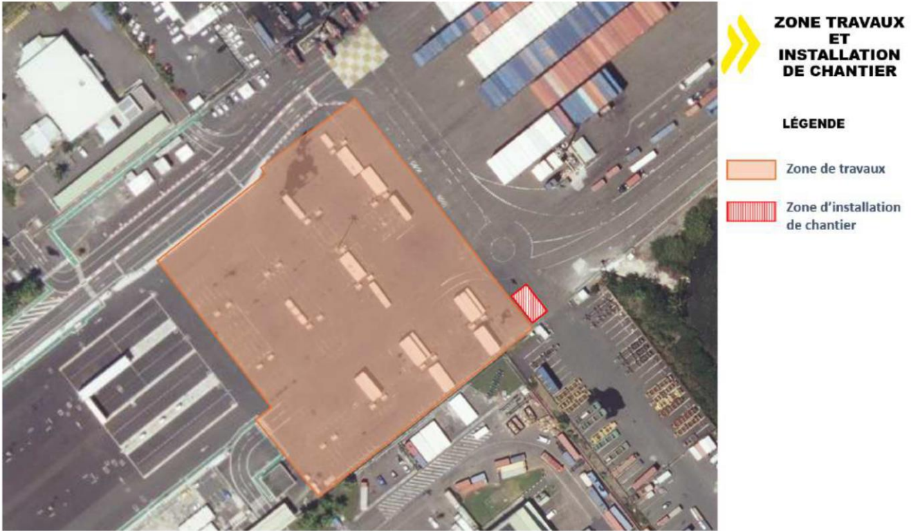
Plan zone travaux et installation de chantier
